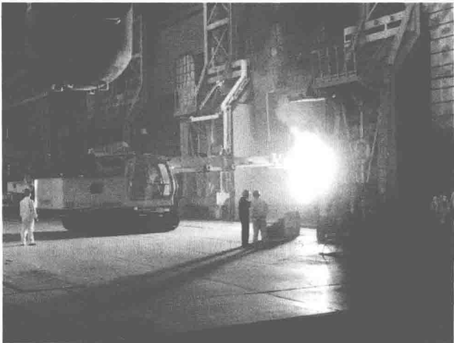
图 8 清理炉口和炉体内衬
