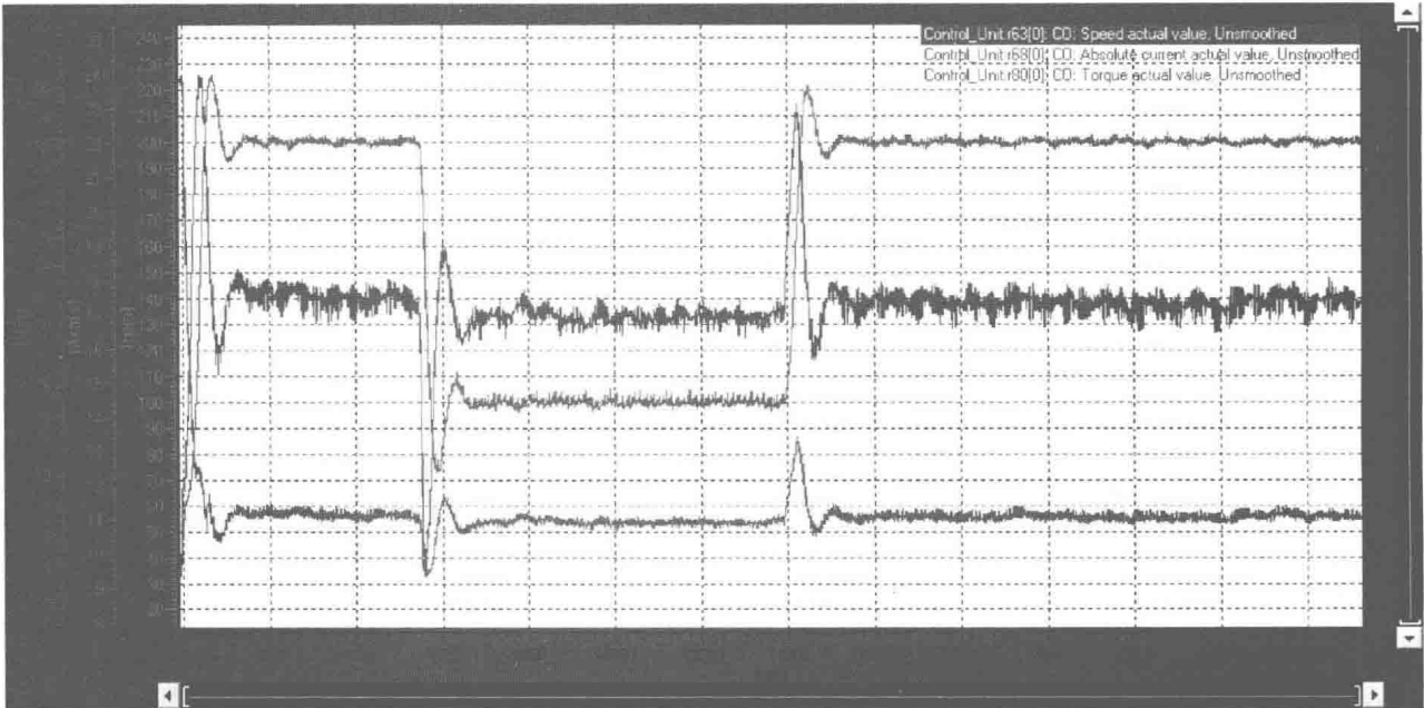
图 7 电动机的转速、电流及转矩波形
