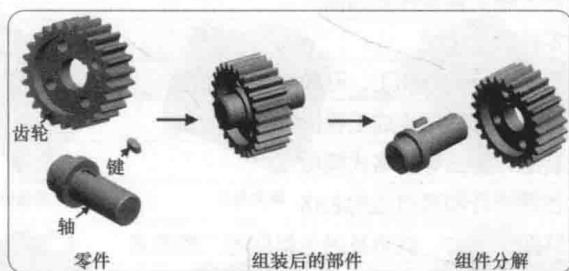
图 1-10 齿轮部件的装配示例
