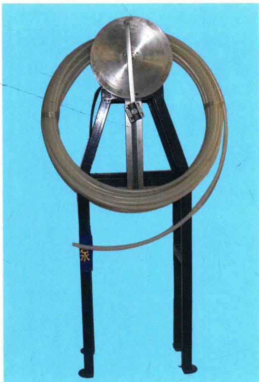
■ 4-029 地下水惯性取样泵 可连续采集地下水样品。可应用于监测井（孔）特别是无电源监测井（孔）的清洗和地下水水样的采取。
