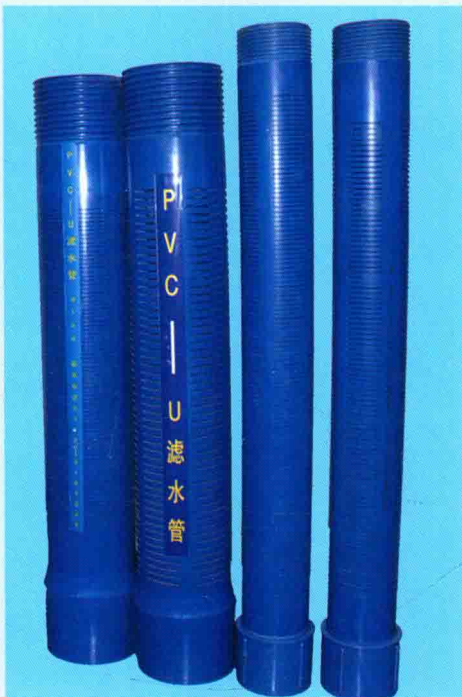
■ 4-032 PVC-U井管 目前水文水井最理想的成井管材。可广泛应用于井深小于500m、水温不大于50℃的供水管井和地下水监测井。
