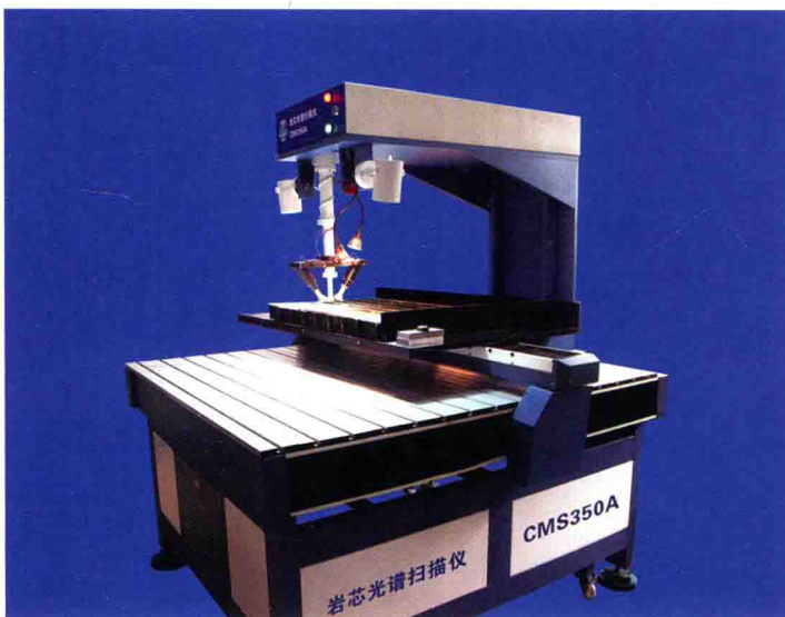
■ 4-019 CMS350A 型全自动数字化岩芯扫描仪 光谱范围350nm-2500nm；扫描范围：1.2m×1.2m； 有效载荷：样品台-300kg；移动台-100kg；测量 对象：岩芯及其中低温蚀变矿物；照片面积： 130mm×100mm。
