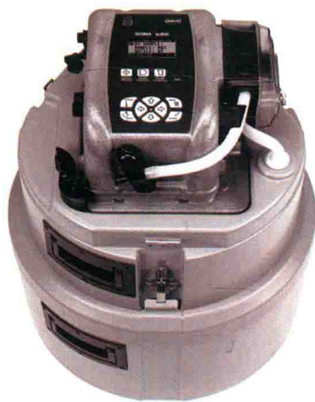
■ 4-028 sigma sd900便捷式采样器 适于NPDES雨水、暴雨流量、采样预处理、CSO研究监测、工业废水及城市污水控制等，有时间间隔、流量比率、复合采样，多瓶采样等模式，可储存三个程序。
