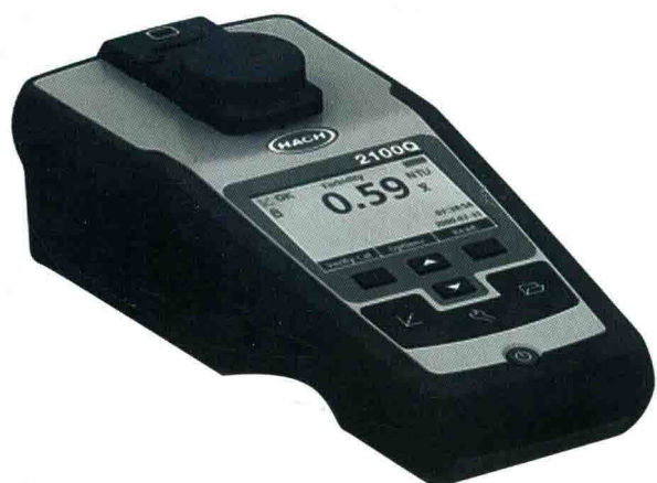
■ 4-005 2100Q便携式浊度仪 测量范围:0~1000NTU; 分辨率:0.01NTU;单点快速校准,非常方便;快速 沉降测量模式可测量快速沉降的样品浊度;可存储 500个测试数据。
