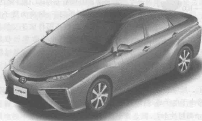
图 1-2 丰田质子交换膜燃料电池车 Mirai
