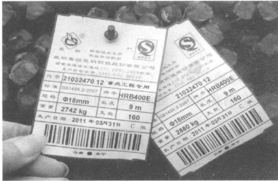
图 1-5 合格钢筋铭牌正确悬挂
