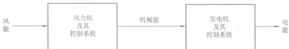
图 1-1 风力发电的能量转换过程
