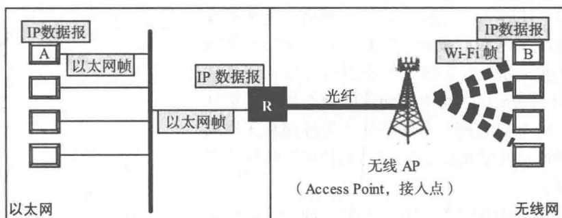
图 1-2 路由器在异构网络互联中所起的作用示意 ②
