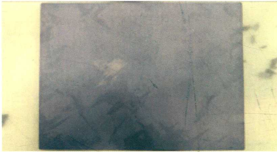
图2-15 减重过低黑硅绒面
