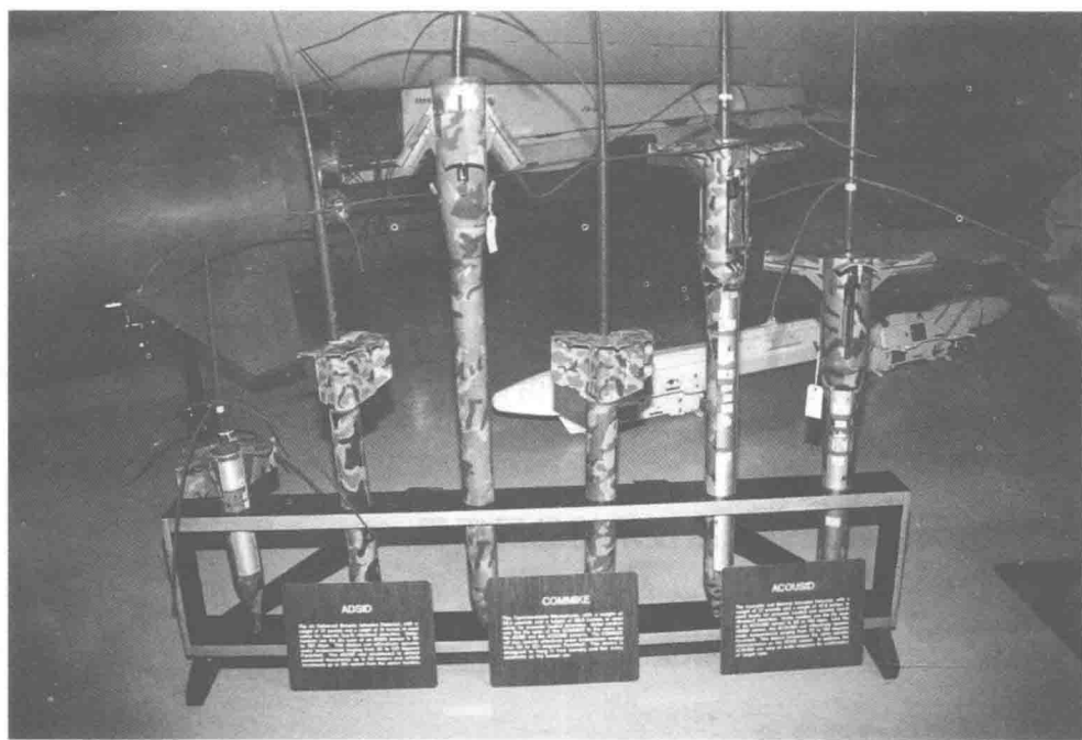
图 1-2 越南战争时期美军使用的无线传感器，被伪装成“热带树”的模样
