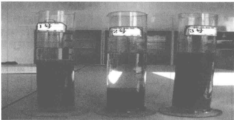
图 5 150℃热滚 16h 静置 24h 三种不同有机土成胶能力图
