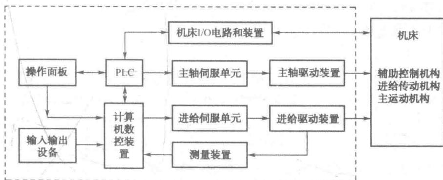
图 1-1 数控机床的工作原理
