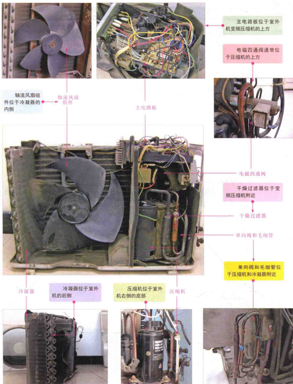
图 1-7 空调器室外机的内部结构
