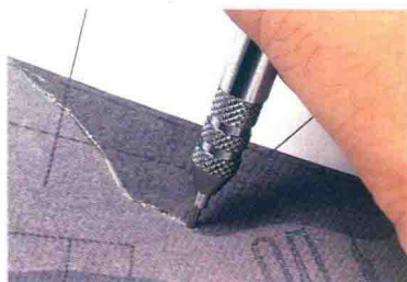
▲随着受力方向的改变，刀刃的转向也会随之灵活转变。
