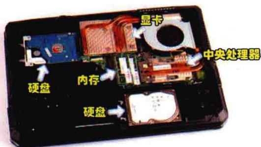
彩图61 便携式计算机内部结构示意图
