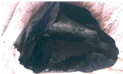
↑ 石油沥青在常温下呈黑色或黑褐色的黏稠的液体、半固体或固体,图中为固态石油沥青。
