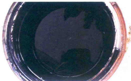
↑ 经过加工熬制后的石油沥青呈黏稠的液体状。
