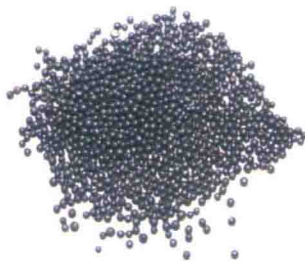
↑ 煤焦油沥青常温下为黑色固体,有光泽但有臭味,熔化时易燃烧并有毒。图中球状沥青是用煤焦油沥青经加热溶解、喷淋、冷却工艺而制成。
