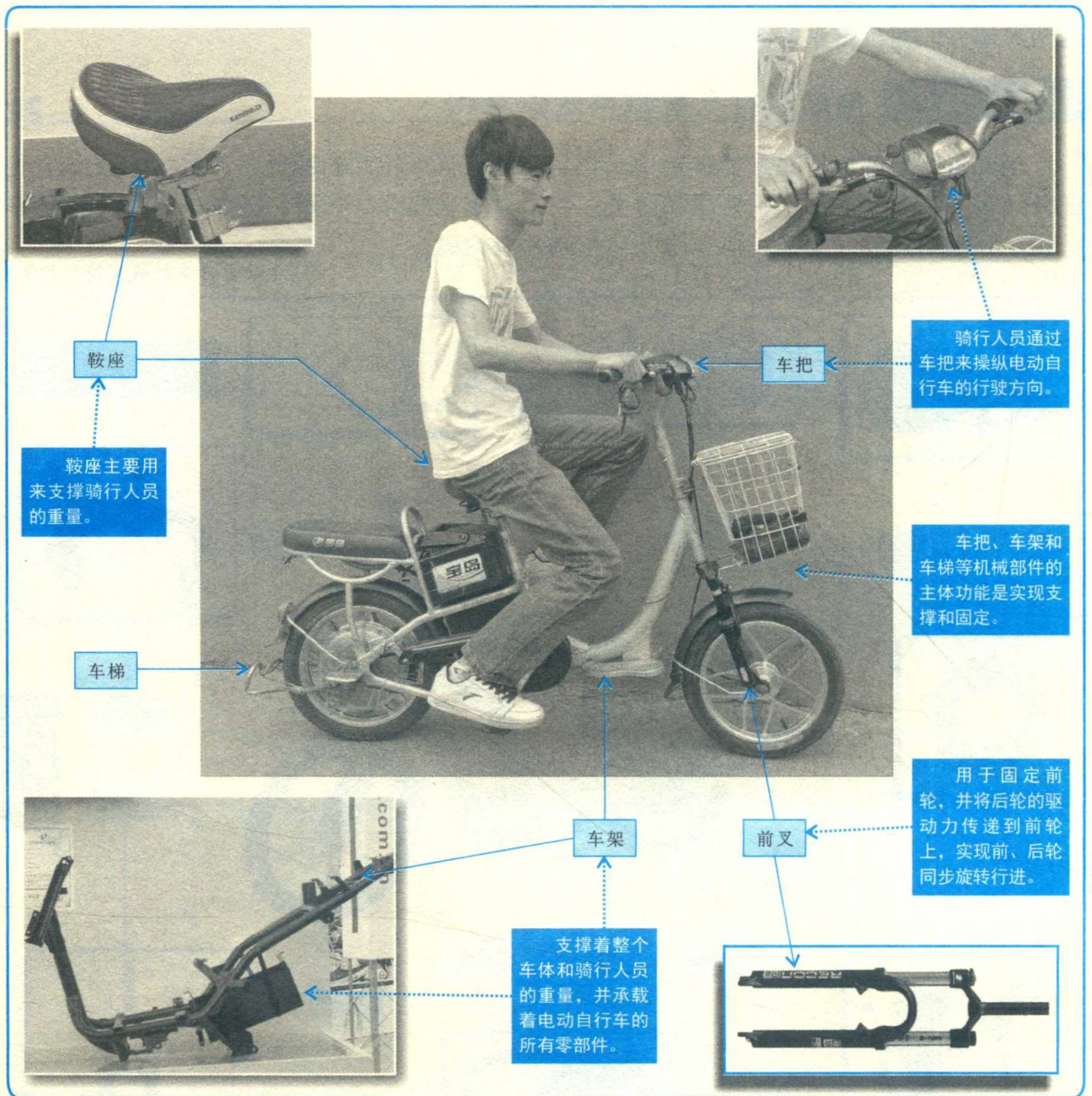
【电动自行车承重部分的结构】
