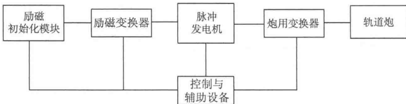
图 1-8 脉冲发电机驱动轨道炮系统的组成
