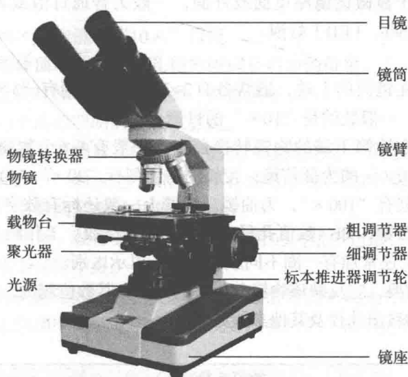
图1-2 普通正置显微镜结构图
