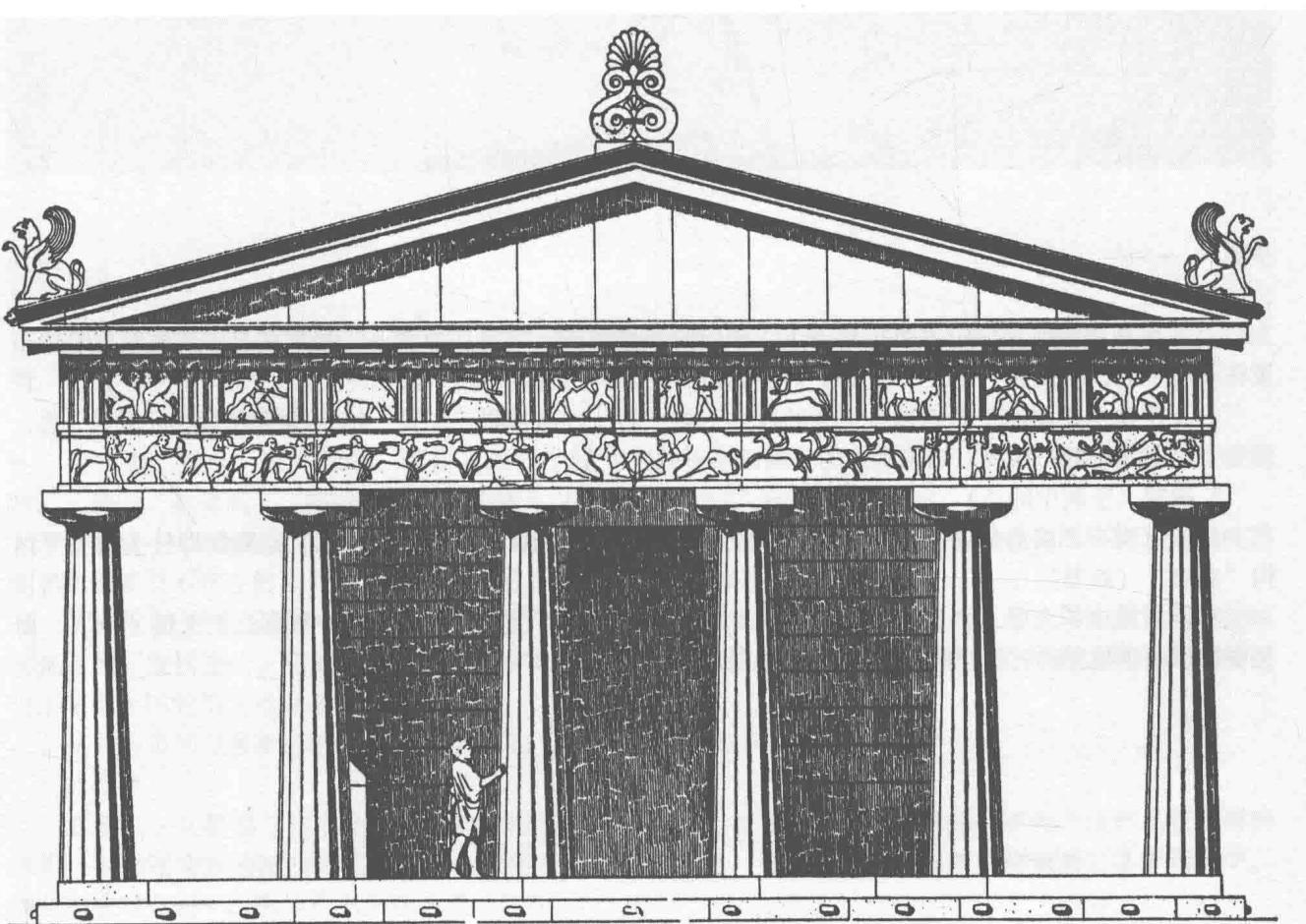
多立克式柱式的风格简单明了。上面部分保留了原来木结构柱头的形式，下面圆柱部分中部略粗、顶端渐细，比例上显得粗重有力，带有男性的特征，因而成为男性的代表。
