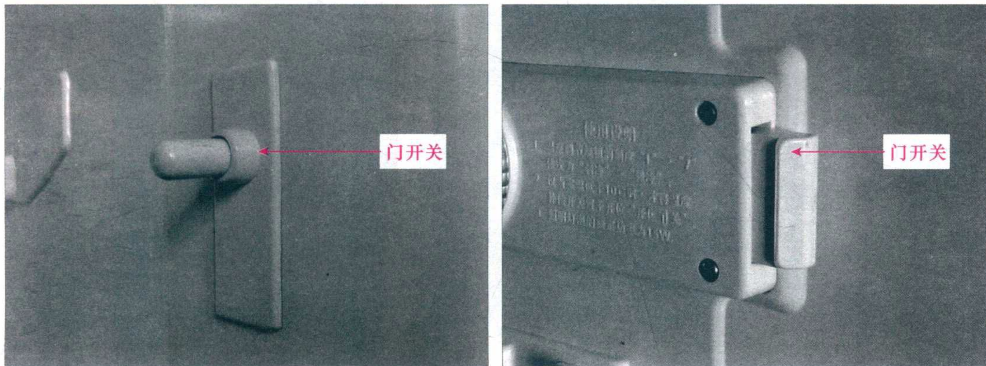
图 1-10 典型电冰箱的门开关
