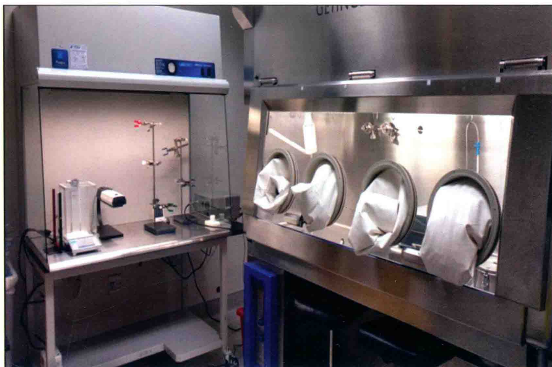
净化台(左侧)和隔离操作台(右侧)
