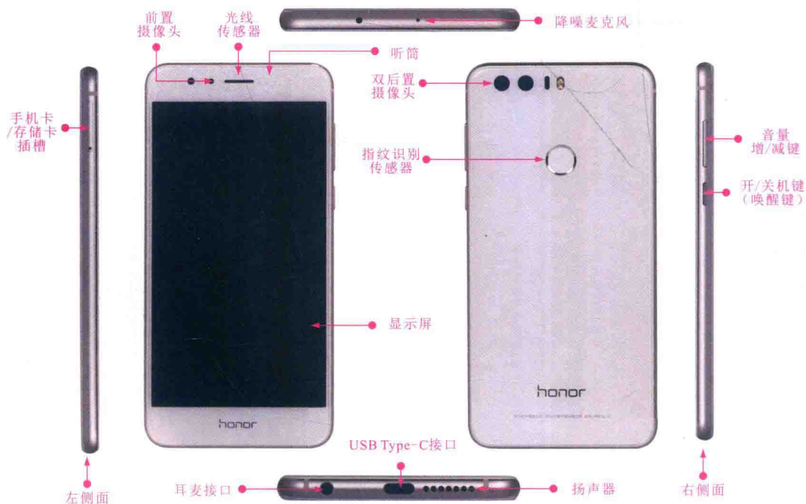
图 1-1 典型智能手机的整机结构（一）
