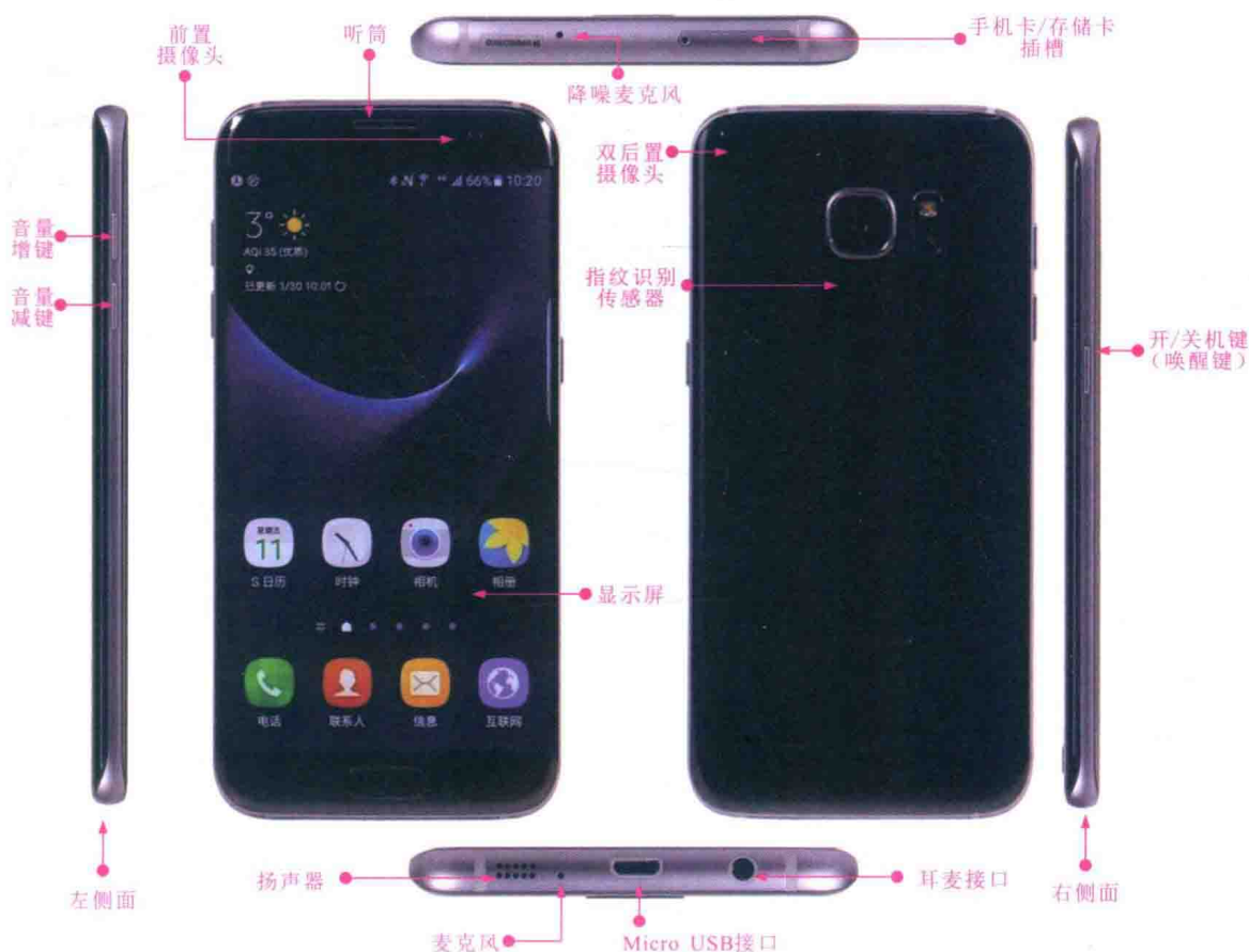
图1-2 典型智能手机的整机结构(二)
