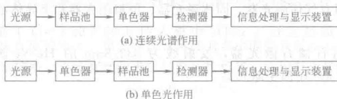
图 2-4 光谱仪基本结构流程
