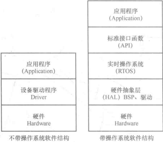
图 1-4 嵌入式两类不同的系统结构模型
