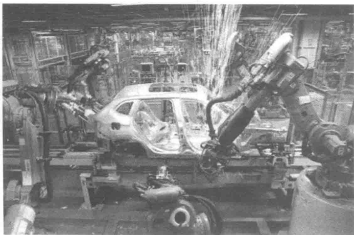
图 1-6 德国宝马工厂中的工业机器人
