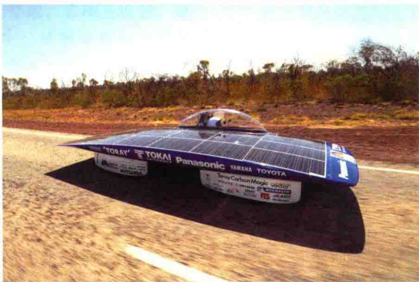
东海大学挑战中心“2013 Tokai Challenger” 为参加World Solar Challenge 2013而开发的赛车。为适应比赛规则的改变，从3轮变成4轮，结果很可惜，只获得第2名
