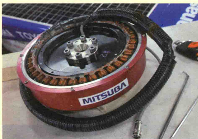
↑ 打开护轮板，即露出轮胎。这里采用的是米其林制造的太阳能车专用16in子午线轮胎。左后轮配置了MITSUBA生产的轮毂型直驱无刷电机。特别准备了特性不同的3种电机，根据赛道的不同进行更换。控制器采用三相PWM控制。
