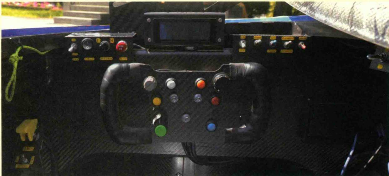
↑ 座舱前面板，配置着液晶显示屏和开关等多种部件。
