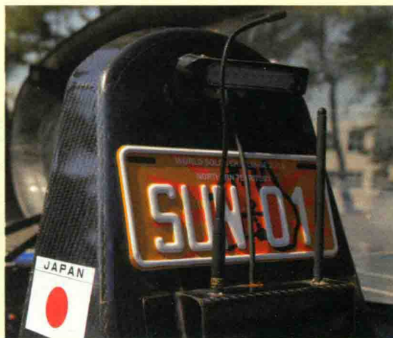
↑ 靠背后面装有车牌“SUN01”，后面还有3根天线。天线不仅用于无线电话，还将车辆的多种信号（速度、油门开度、电机电流和发电电流、电池电流和电压、电池各单元的电压等）发送到控制中心。
