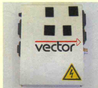
↓ 车内仪表与控制装置通过汽车行业使用的CAN（Controller Area Network）总线连接，CAN数据分析与记录采用VECTOR日本公司制造的CANalyzer和GL1000等。
