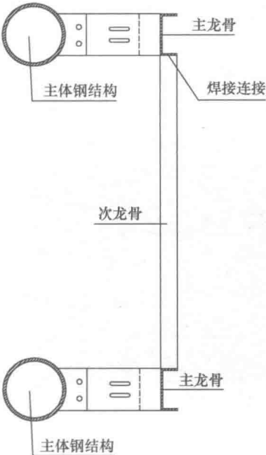
图 1-6 主次龙骨焊接图
