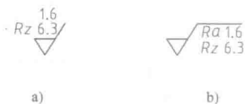
图 1-27 表面粗糙度表示形式 a) 旧标准 b) 新标准
