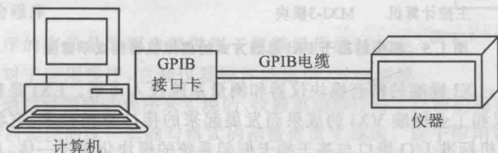
图 1.3 典型的基于 GPIB 总线方式的虚拟仪器系统构成示意图
