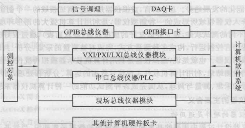
图 1.1 虚拟仪器的硬件结构
