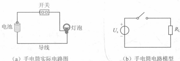
图 1-1 手电筒实际电路图与电路模型
