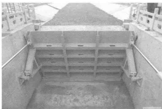
图 5-6 弧形闸门厂内总拼示意图
