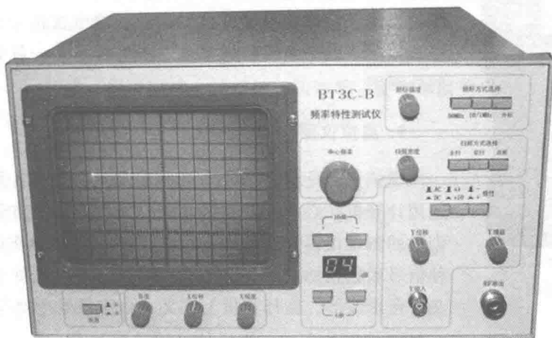
图 1.5 数字式频率特性测试仪的外形图
