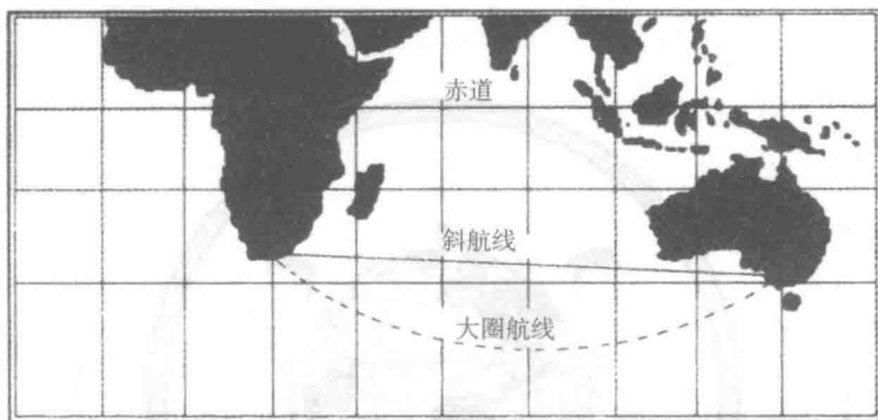
图1 在航海图上，从好望角到澳大利亚南部的最短航线不是直线（斜航线），而是曲线（大圈航线）
