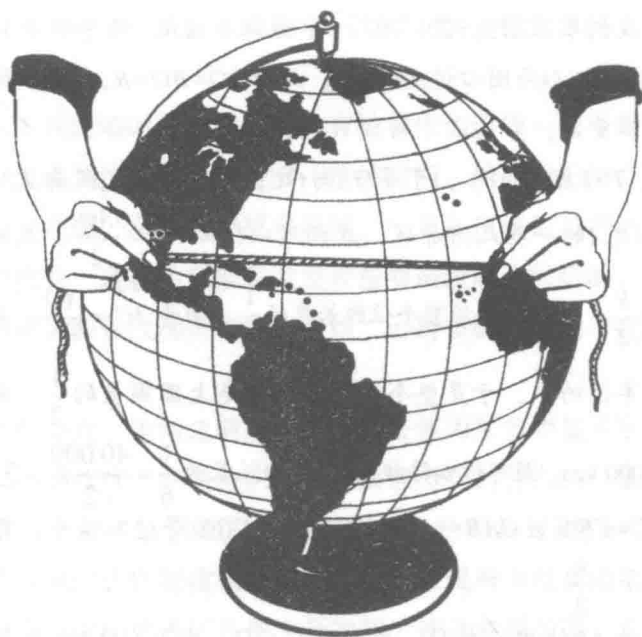
图4 用一种简单的方法就可以找出两点之间的最短距离： 将地球仪上的这两点之间拉紧一条线
