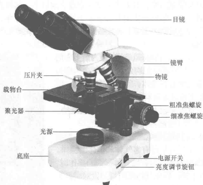
图 1-12 光学显微镜的构造
