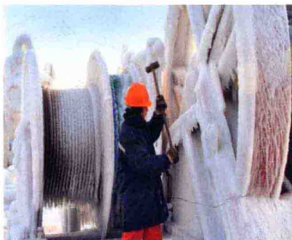
甲板设备除冰作业。
