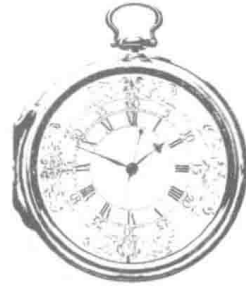
图 1-2 Harrison 制造的 H4，第一个用于准确航海计时的手持式钟表，用于确定经度
