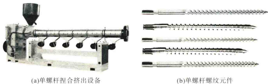
图 1.2 单螺杆捏合挤出设备及其元件
