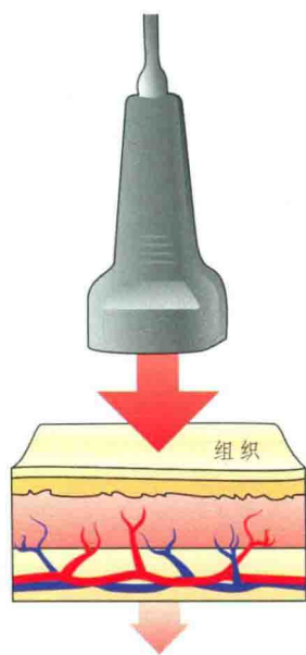
图 2.4 示意图显示入射声波(红色箭头)在穿过组织时出现衰减。由于入射声波的部分反射、折射和吸收,继续传播的声波变弱。
