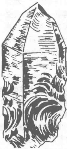
图 1-4 单晶石英的贝壳状断口
