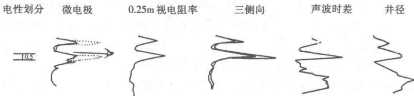
图 2 南 1—6—37 井萨 II 7 层电性划分与岩心划分有效厚度对比实例
