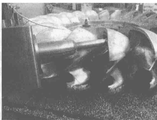
图 1-5 水轮机水斗插铣加工
