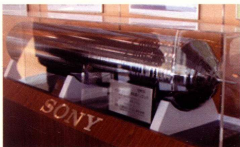
图 1.2 在日本索尼公司(SONY)九州工厂门厅陈列的高纯硅(Si)单晶晶锭照片。这个晶锭是日本三菱住友材料公司2004年6月采用特制的超大型高温熔体提拉技术系统制备的。晶锭的直径为300mm(约12in)，长度为215cm，质量为307kg，纯度为99.99999999%
