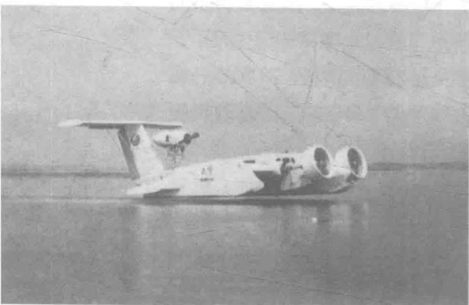
浮舟来代替。这样，地效翼艇在停泊时，由艇体及其浮舟提供静浮力；起飞时，利用水动力与地效翼产生的升力来支撑艇体，使其在水面上飞行。
