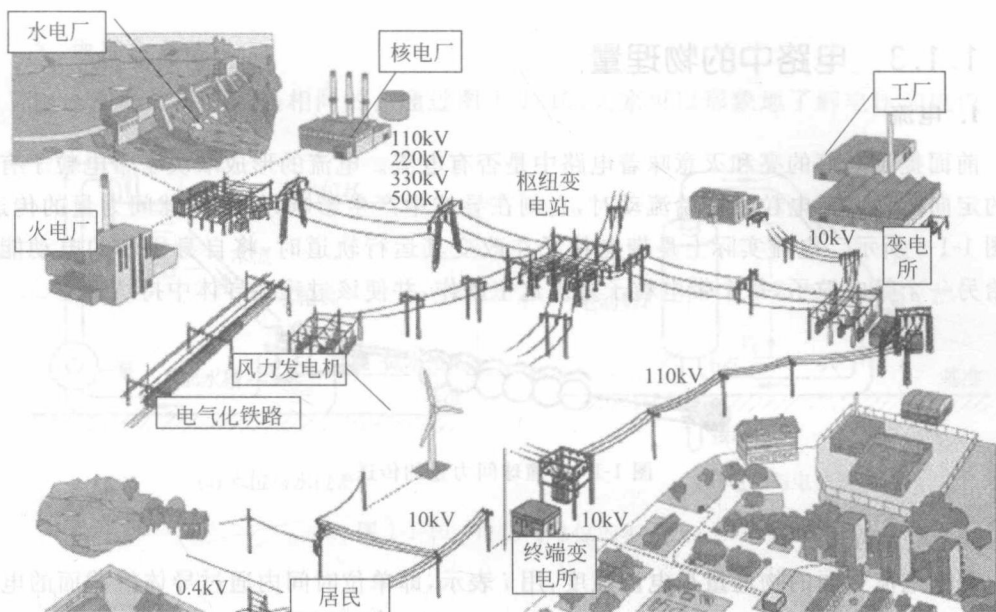
图 1-1-3 电力系统供电电路
