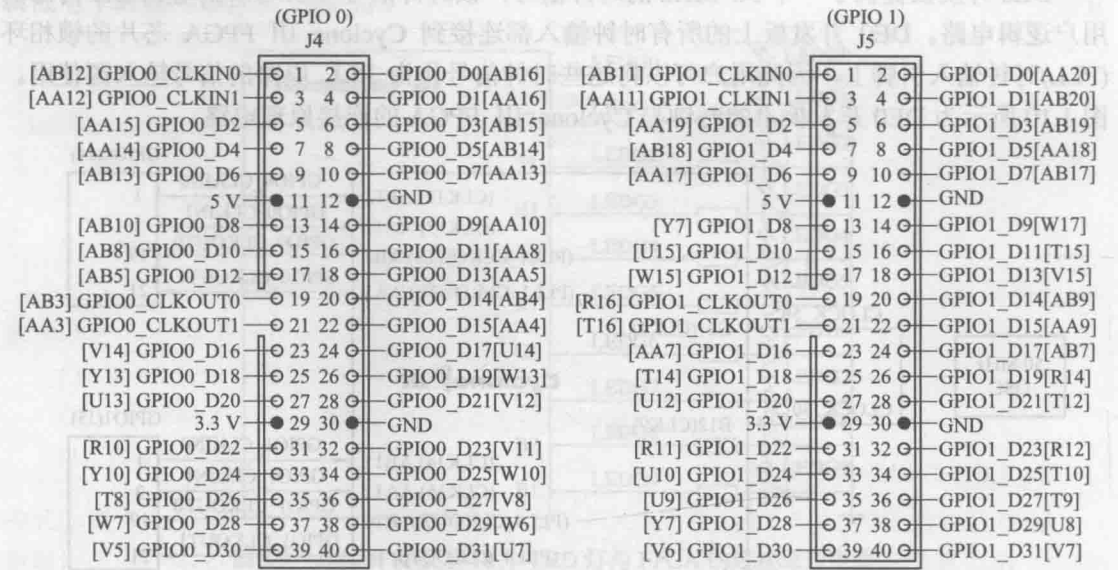
图 1.12 DE0 开发板两个 40 针扩展接口与 Cyclone III FPGA 芯片的连接示意图
