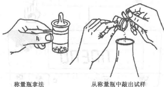
图 1.2 称量瓶使用示意图
