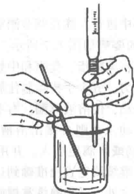
图 1.9 在烧杯中滴定
