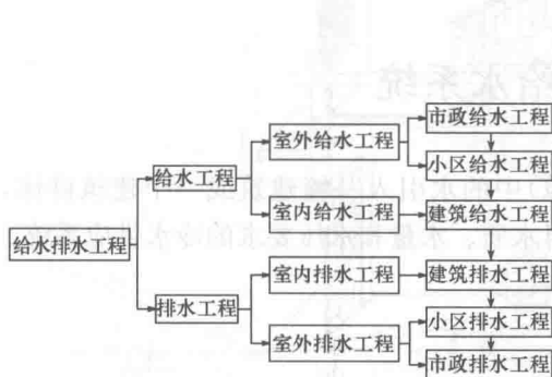
图 1-1 城市给水排水工程体系组成示意图
