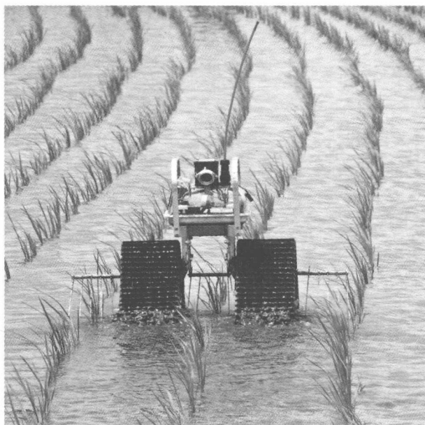
图 1.4 稻鸭机器人（日本岐阜县情报技术研究所） 通过强力的履带动作进行插秧后的除草
