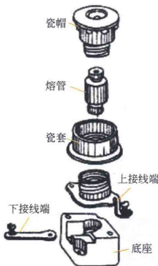
图 1-8 螺旋式熔断器的结构图
