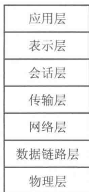
图 1-6 OSI/RM 七层网络模型
