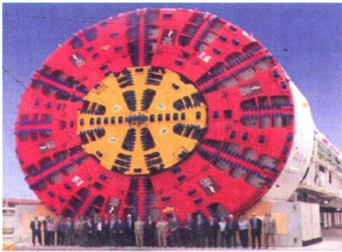
图 1-3 马德里 M30 地下道路隧道 \Phi 15.2\text{m} 双子星土压盾构
